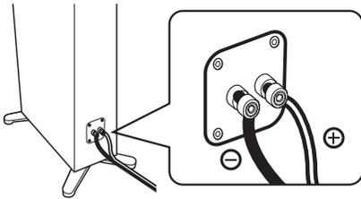
Un des conducteurs a une couleur ou un marquage (ruban, rainure, dentelure) qui le distingue de l'autre. Reliez le conducteur repéré (rainure, etc.) aux bornes "+" (rouges) de l'enceinte. Reliez l'autre conducteur (non repéré) aux bornes "-" (noires).
