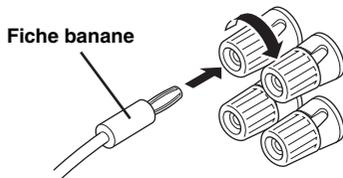
■ Raccordements des enceintes aux bornes FRONT B, CENTER et SURROUND
