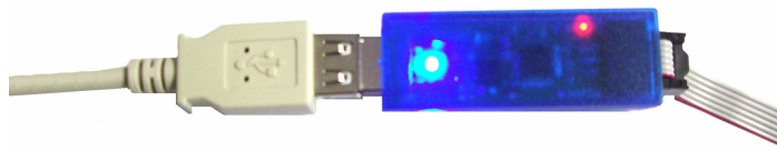
mySmartUSB light mit USB Verlängerung zur Verwendung am PC und ISP Kabel / Utilisation de mySmartUSB light avec un câble d'extension USB vers le PC et connexion ISP
