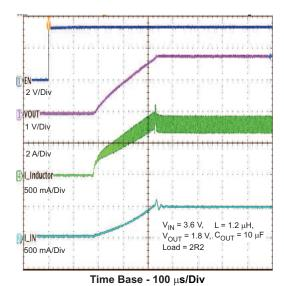
Figure 20. Startup Into Load - V<sub>OUT</sub> 1.8V
