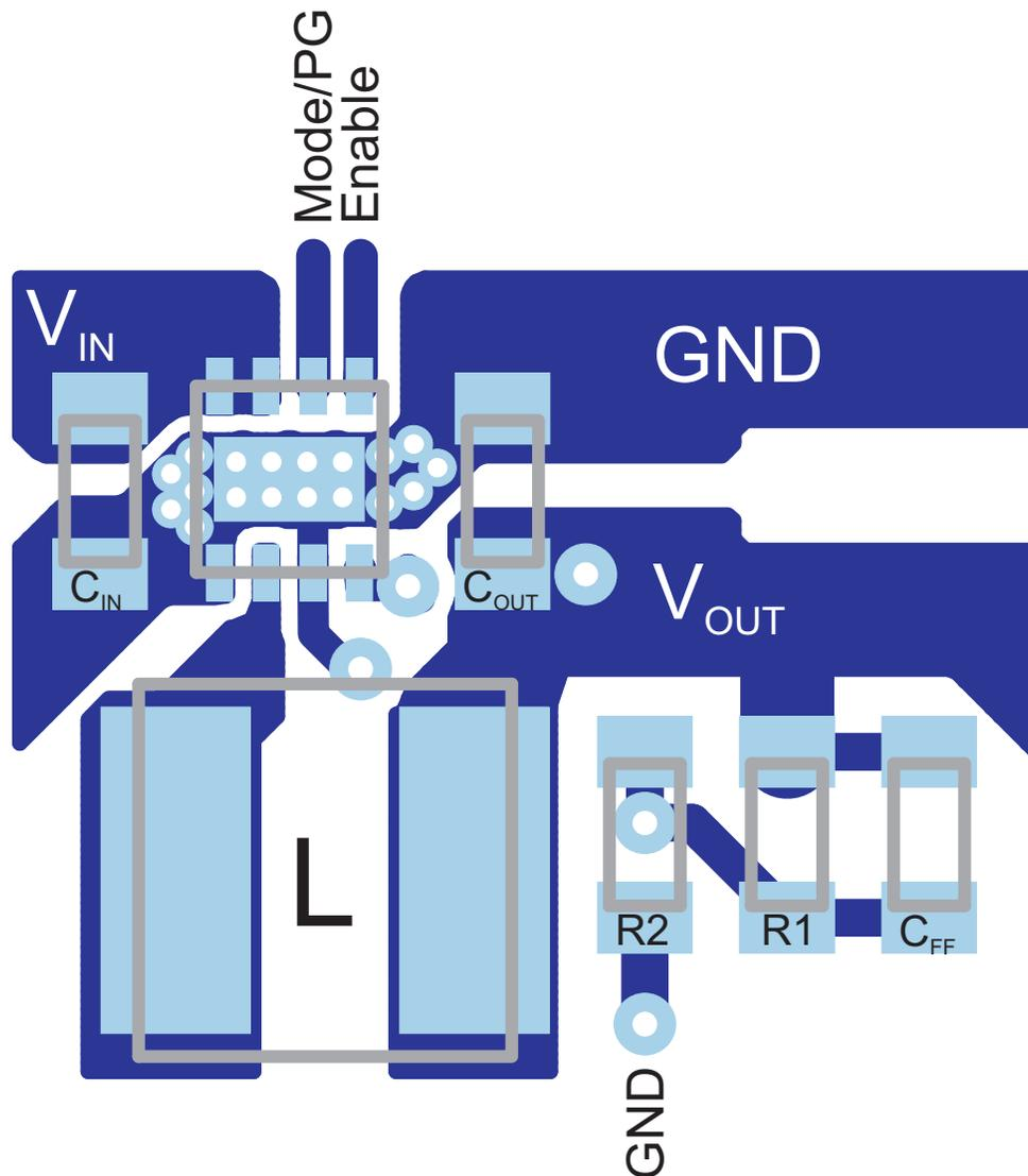
**Figure 28. PCB Layout**
