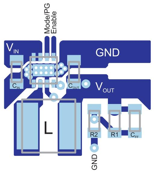
Figure 28. PCB Layout
