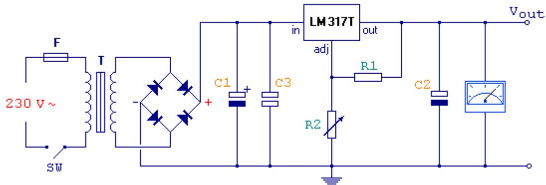
Le schéma de l'alimentation variable s'articule autour d'un régulateur LM317T. Le galvanomètre, facultatif, est fortement conseillé pour un meilleur confort d'utilisation.
