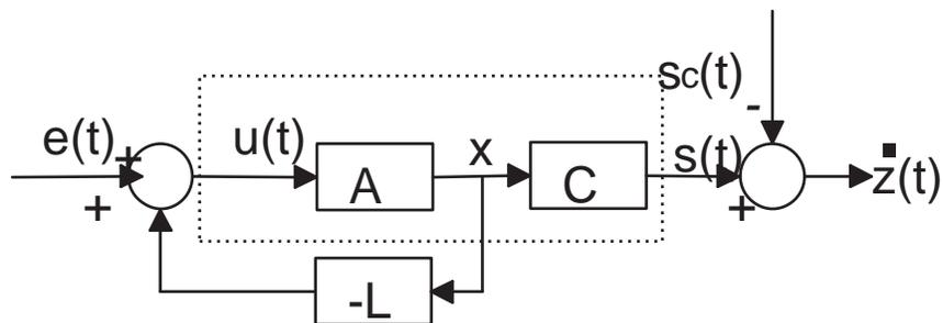
FIG. 3.4 – Annulation de l'erreur statique par une commande intégrale : la consigne en sortie est vue comme une perturbation.
