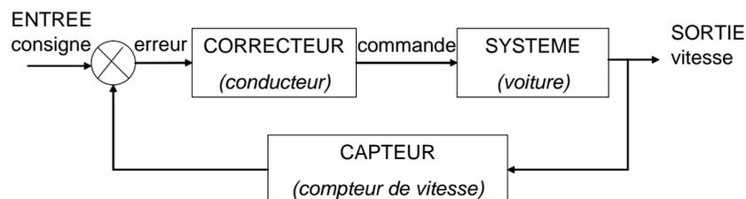
FIG. 1 – Structure d'un système asservi : rétroaction (boucle fermée) et correction.
