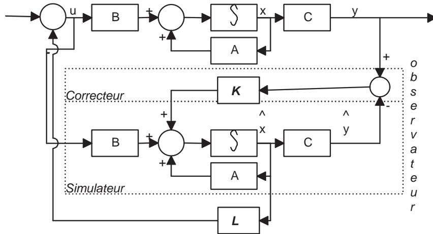
FIG. 4.3 – Structure de la commande avec synthèse d'un observateur
