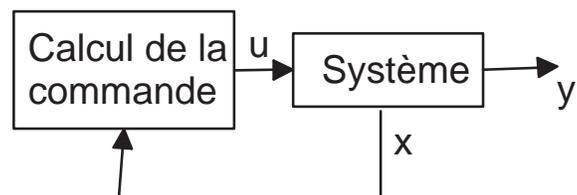
FIG. 4.1 – Structure de la commande dans le cas où l'état est mesurable
