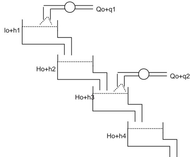
FIG. 6.2 – Quatre cuves en cascade alimentées par des électro-vannes
