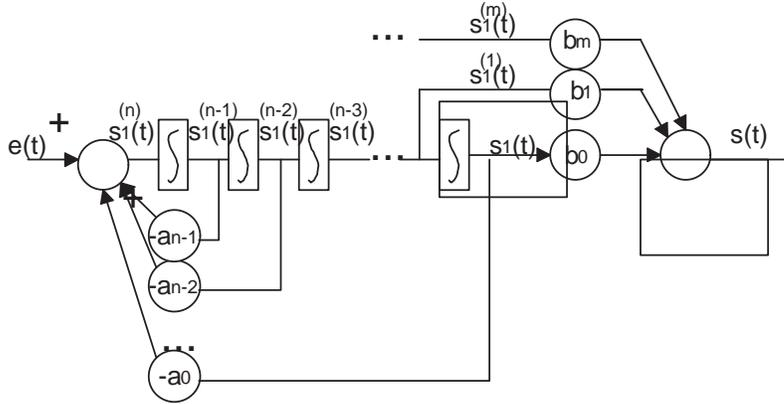
FIG. 2.1 – Interprétation d'un système complexe sous la forme d'une mise en série d'intégrateurs purs
