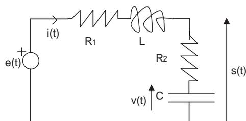
FIG. 1.1 – Exemple d'un système électronique
