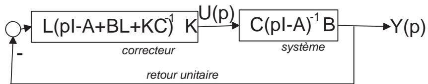
FIG. 4.4 – Structure d'asservissement classique
