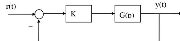
On augmente le gain K de la figure ci-dessus de manière à rendre le système oscillant (limite de stabilité). Soit  $K_u$  cette valeur limite de K et  $P_u$  la période des oscillations observée. On peut donc choisir comme paramètres du régulateur :
