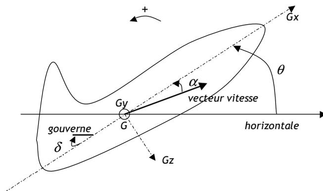
Figure 1: Etude du mouvement de tangage d'un avion.
