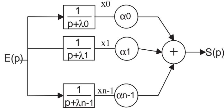
FIG. 2.2 – Interprétation d'un système complexe sous la forme d'une mise en parallèle de systèmes d'ordre 1
