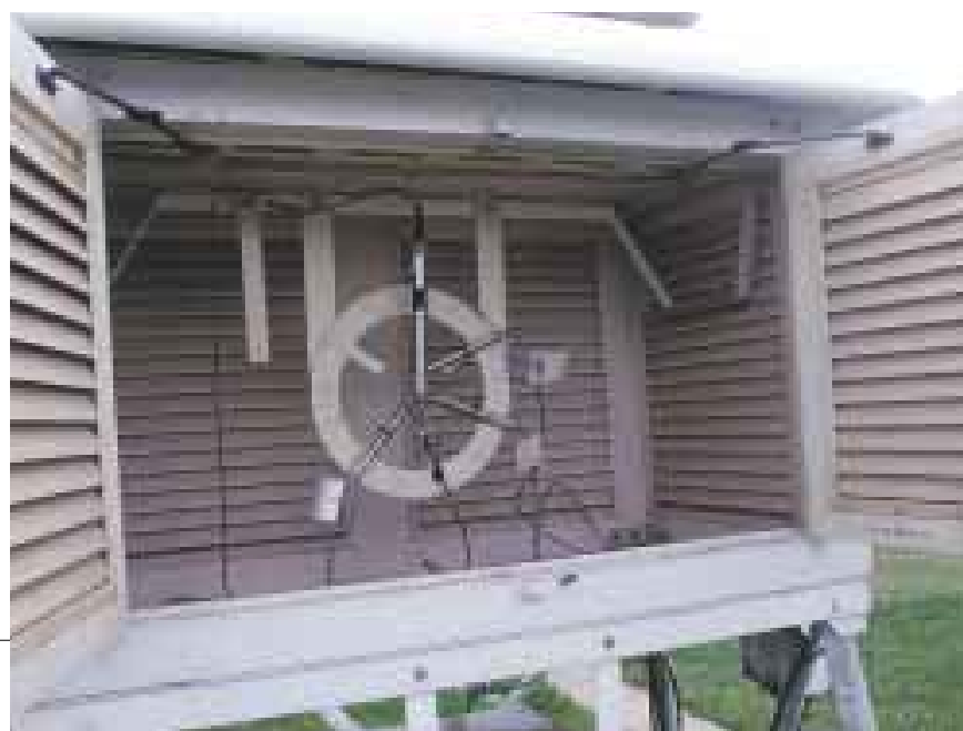
Photo 5 - Capteurs dans un abri. Le capteur de température à fil de platine est la petite sonde en bas de la rosace. (Photo Météo-France, P. Taburet)
