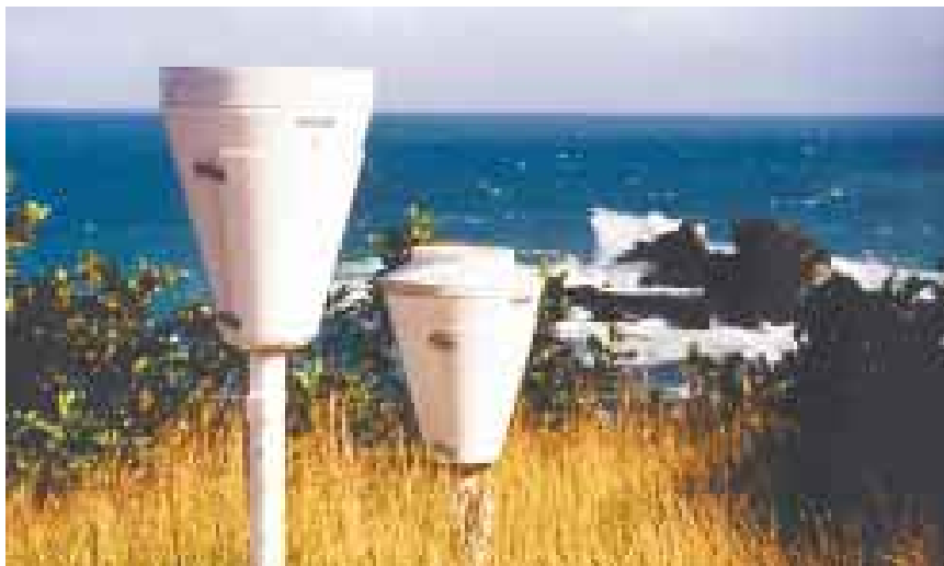
Photo 8 - Deux pluviomètres à augets basculeurs de la station de La Caravelle en Martinique. (Photo Météo-France, P. Frayssinet)
