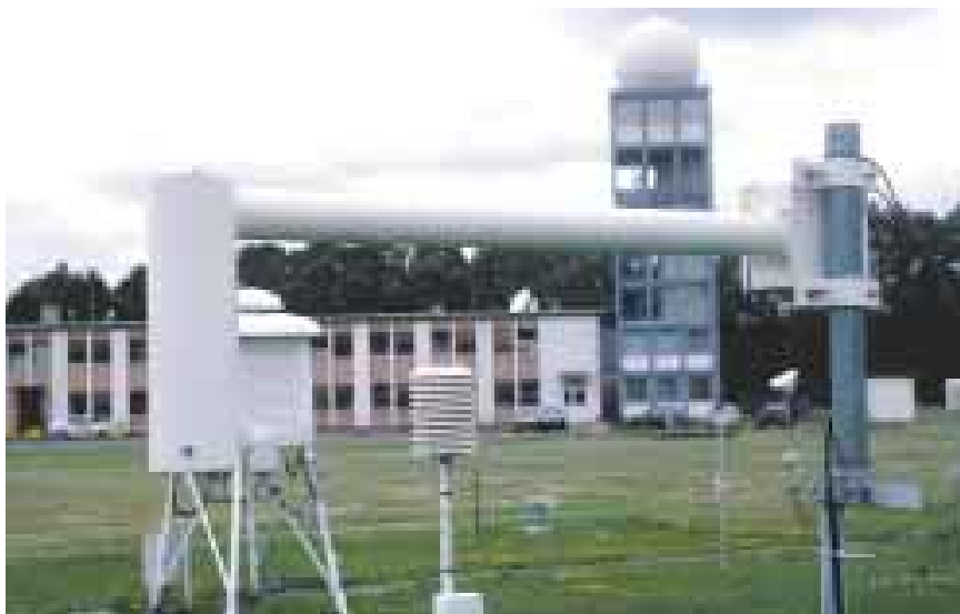
Photo 4 - Différents abris en test à Trappes en 1997. Au premier plan, abri ventilé américain Qualimetrics. (Photo Météo-France, P. Taburet)
