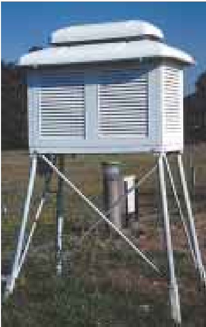
Photo 1 - Abri météorologique grand modèle de type Stevenson. (Photo Météo-France)
