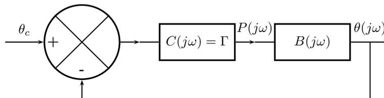
FIG. 8 – Système bouclé
