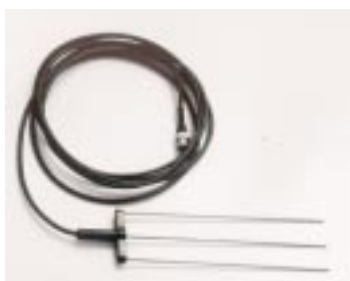
Figure 64 : sonde TDR trifide, 20 cm de long (SoilMoisture Eq. Corp)
