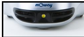
Image 12. Localisation des capteurs d'obstacles
