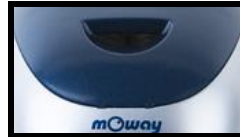
Image 13. Orifice du capteur de luminosité
