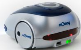
Image 16. Localisation de la DEL de frein rouge. La DEL verte allumée est le voyant de mise sous tension, elle est non contrôlable
