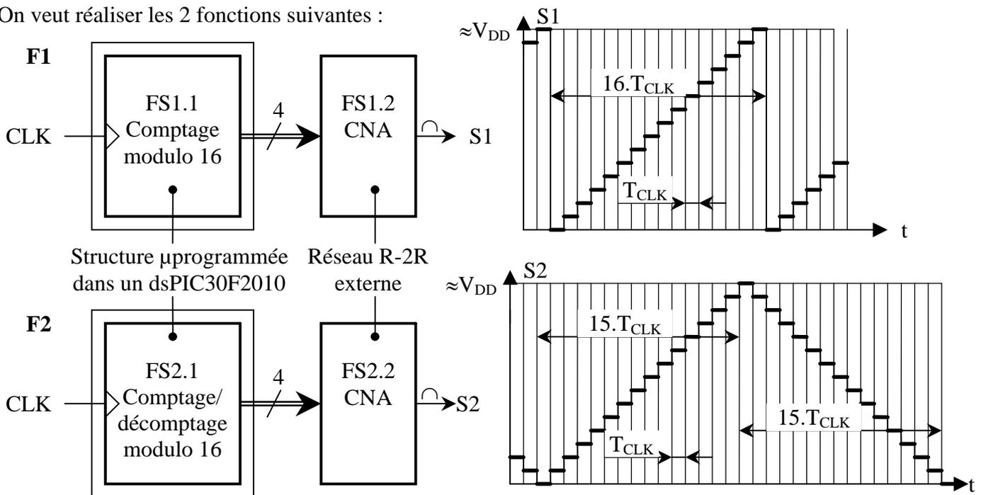
Il s'agit donc de générateurs de signaux "dents de scie" et "triangle" dont la fréquence est définie par le signal CLK externe.
