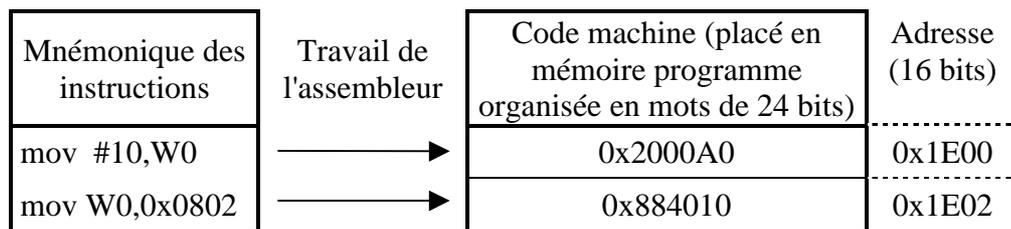
On constate qu'une instruction est codée sur un seul mot de 24 bits dans la mémoire programme. Ce type de codage permet d'augmenter la vitesse de traitement en réduisant le nombre d'accès mémoire par instruction.
