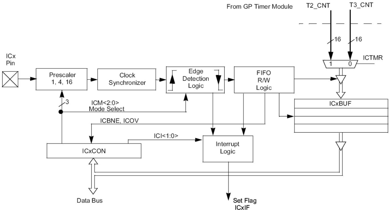
La structure "Input Capture 1" (associée à l'entrée IC1) est configurée par les états quelques bits du registre IC1CON :
