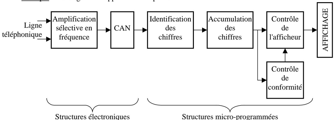
La structure électronique fournit un flux numérique continu représentatif du signal analogique prélevé sur la ligne téléphonique.
