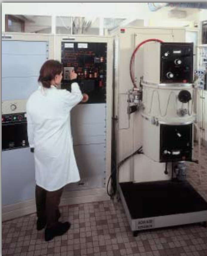
Machine de dépôt sous vide
