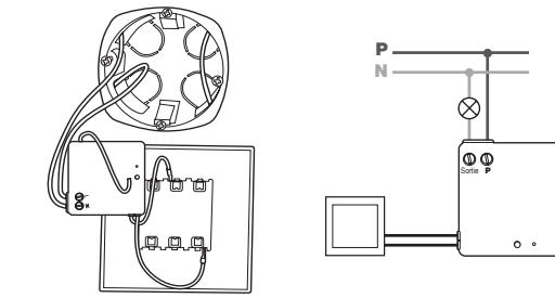
Connectez le module comme ci-dessus. Les 2 fils noirs sont à connecter derrière l'interrupteur. **Ne pas les connecter au réseau électrique.**
