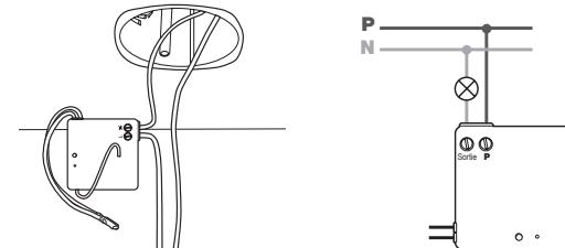
Connectez le module comme ci-dessus. Les 2 fils noirs sont inutilisés : isolez-les à l'aide de ruban adhésif isolant, ou coupez-les.
