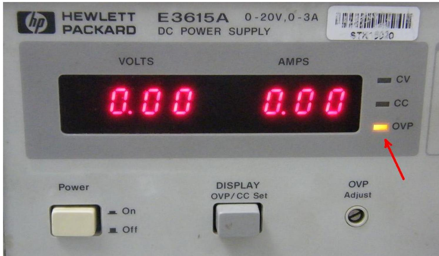
le Fait d'alimenter la carte a testé avec l'alimentation stabilisé sans mise a la terre cette dernière se met en sécurité lord de la production des étincelle en indiquant OVP : Protection contre les surtensions qui est réglé à 25V !!!
