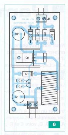
pour un courant maximum de 5 A, provenant de chez Electronique Diffusion. Vous pouvez utiliser une valeur allant de 150  $\mu$ H à 800  $\mu$ H, seul le rendement risque d'être un peu différent. Il est bien sûr impératif que le tore et le fil émaillé soient dimensionnés pour un courant de quelques ampères.
