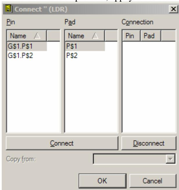
Pin représente le nœud du symbole et pad représente le nœud du package sélectionnez le pin et le pad correspond puis appuyez sur connect (ici l'ordre est déjà établi, il suffit d'appuyer
