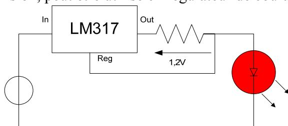
Pour calculer R, c'est très simple, le régulateur fait en sorte que la tension entre Reg et Out
