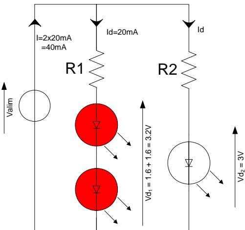
On trouve alors  $R_1=90 \Omega$  et  $R_2=100 \Omega$
