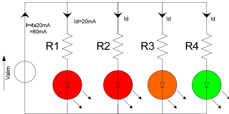
La solution vient encore des résistances qui vont absorber la différence de tension entre l'alimentation et chaque LED!
