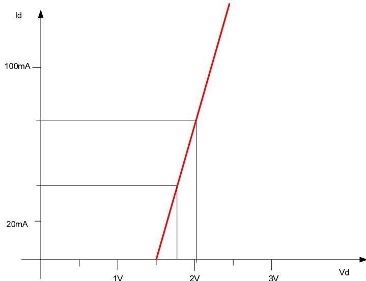
Ici par exemple,  $V_d$  vaut 1.5V (cette tension correspond au seuil de la diode). La pente que l'on observe ensuite est due à la résistance en série  $R_d$ . Cette pente est d'autant plus importante que la résistance est faible.
