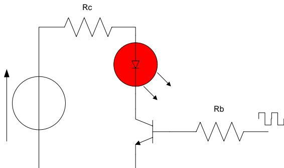
On génère les impulsions avec un NE555 par exemple et on calcule  $Rc$  de façon à calibrer le courant max et  $Rb$  afin de saturer le transistor. Tout ceci est expliqué dans les rubriques sur le NE555 et le transistor bipolaire.
