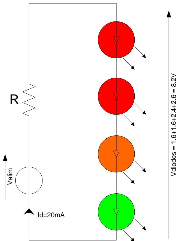
Voilà, alors on a mis nos DEL en série, et la somme des tensions, pour un courant de 20mA est d'environ 8.2V. On veux réguler ce courant. On ajoute pour cela une résistance qui va nous permettre cela ! Il faut connaître la tension de la batterie que l'on utilise, par exemple 12V. Et notre résistance va « absorber » la différence de tension.
