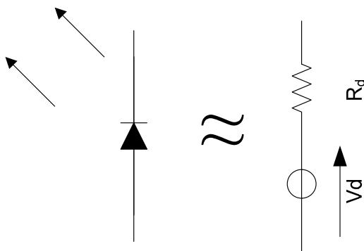
En fait, une DEL est équivalente à un générateur de tension  $V_d$  en série avec une résistance  $R_d$ . (ATTENTION : ça ne veux pas dire qu'une DEL produit de l'électricité, ça veux dire qu'elle « bloque » toujours un peu de tension).
