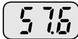
En envoyant l'info de marche avant aux entrées logiques (commutateur 3 positions sur l'entrée logique P1), la fréquence va s'incrémenter pour atteindre la consigne fixée. La led **FWD** (FORWARD) sera active.
