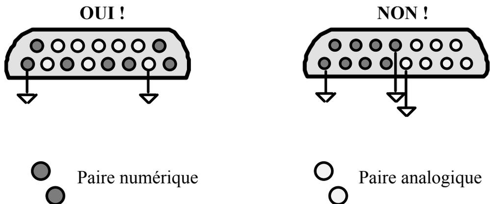
**Figure 29 : Séparation des signaux dans un connecteur**
