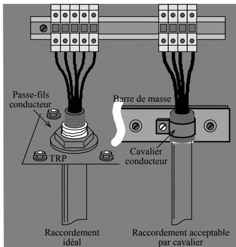
**Figure 42: Raccordement des câbles blindés sur borniers**
