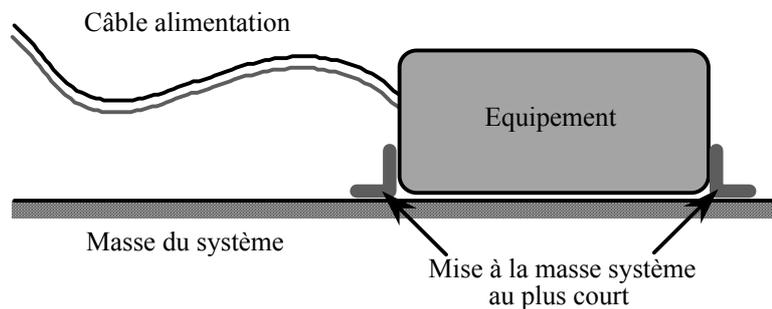
**Figure 27 : Mise à la masse des équipements**
