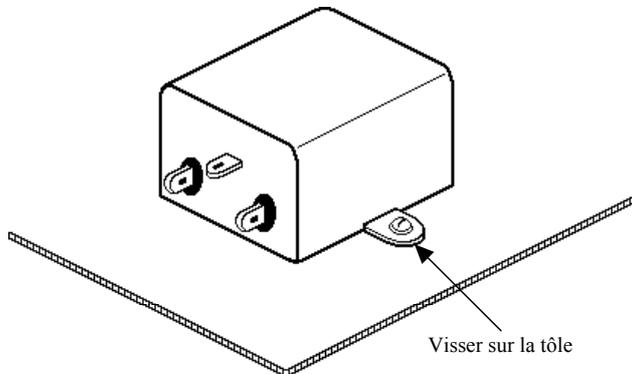
Fig. 34 : Montage d'un filtre – Règle n°1
