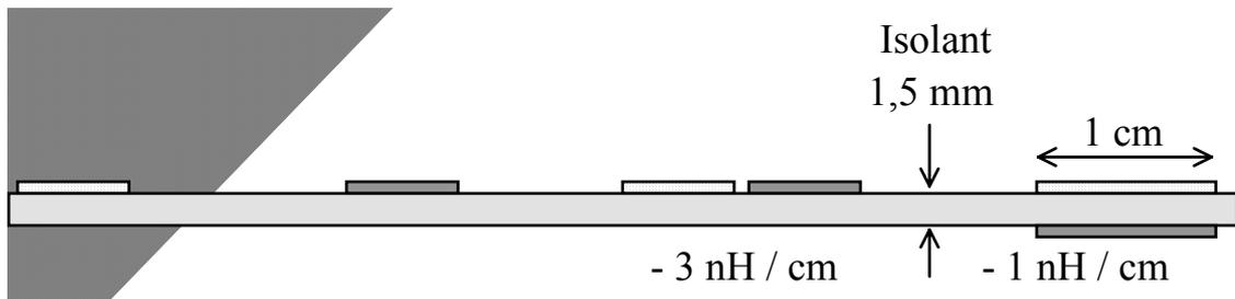
Figure 6 : Réduction de la self des conducteurs
