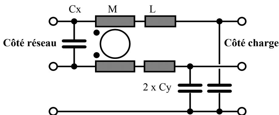
**Figure 33 : Exemple de filtre d'alimentation secteur**
