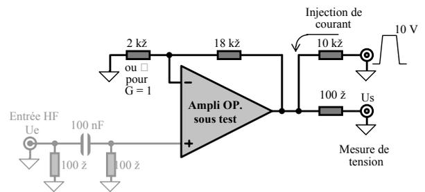
**Figure 10 : Mesure de l'impédance de sortie d'un ampli.**
