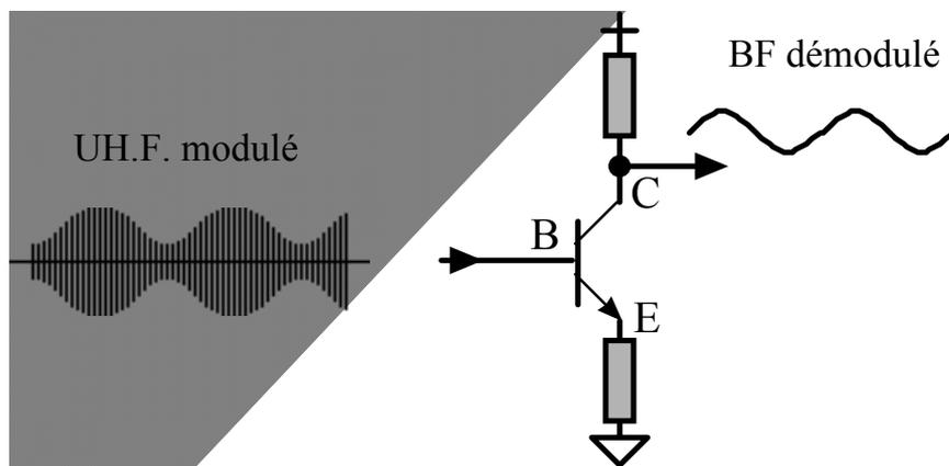
Figure 7 : Détection d'enveloppe
