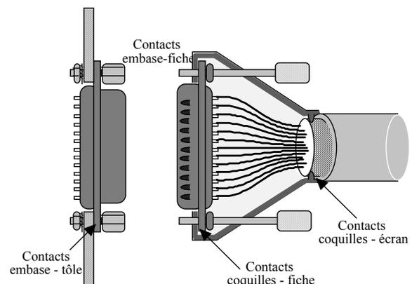
**Figure 43 : Raccordement des câbles blindés par connecteurs**
