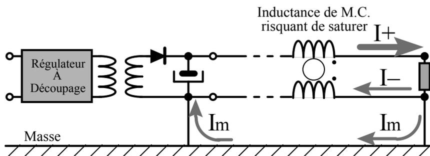
**Figure 40 : Saturation d'une self de mode commun**
