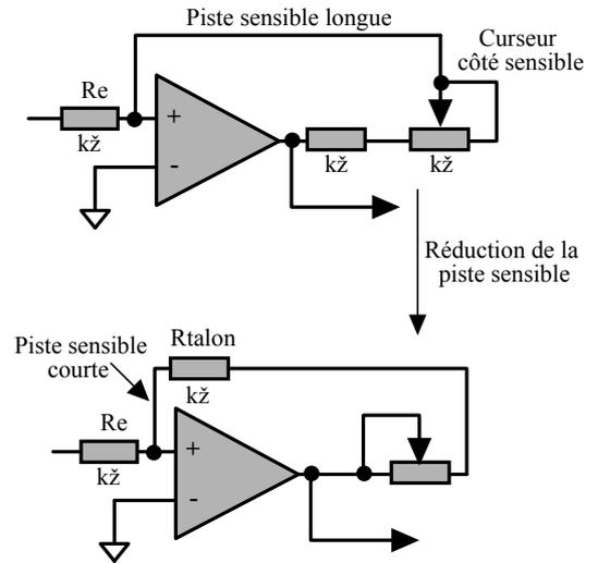
**Figure 26 : Autre exemple de placement**
