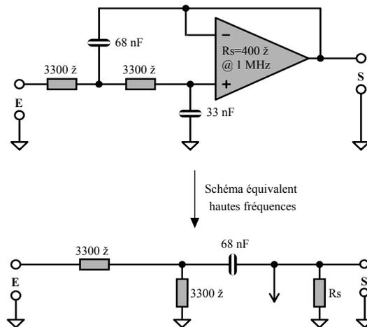
Figure 8 : Effet de l'impédance de sortie en HF
