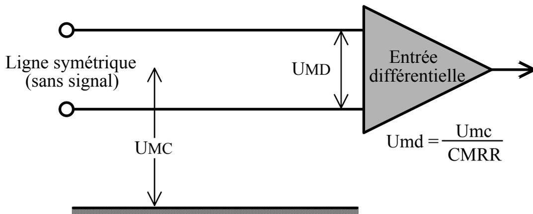
Figure 32 : Réjection de mode commun d'une entrée différentielle
