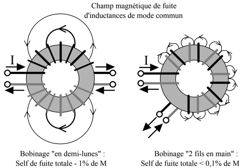
**Figure 39 : Bobinages des selfs de mode commun**
