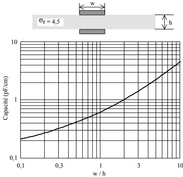
Figure 19 : Capacité parasite couche à couche
