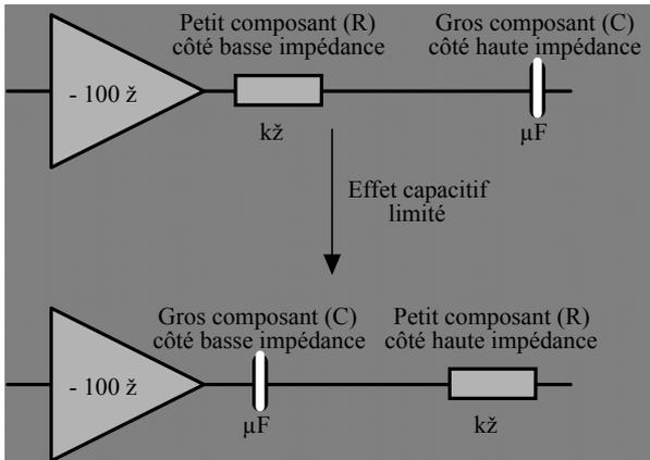
**Figure 25 : Exemple de placement**
