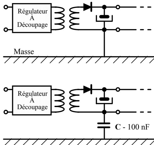
Figure 13 : Raccordement du 0V en sortie de convertisseurs
