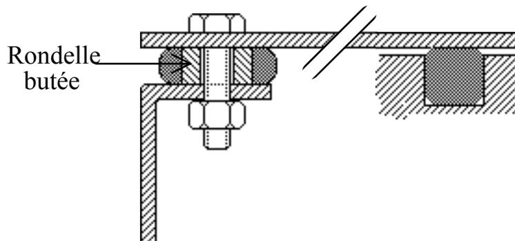
Figure 45 : Mise en œuvre de joints conducteurs
