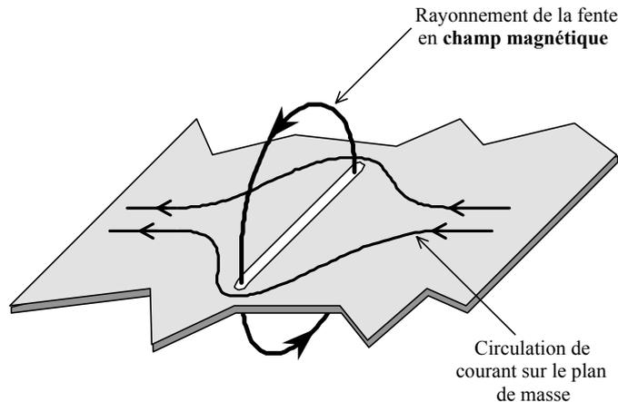
**Figure 4 : Effet d'une fente dans un plan de masse**
