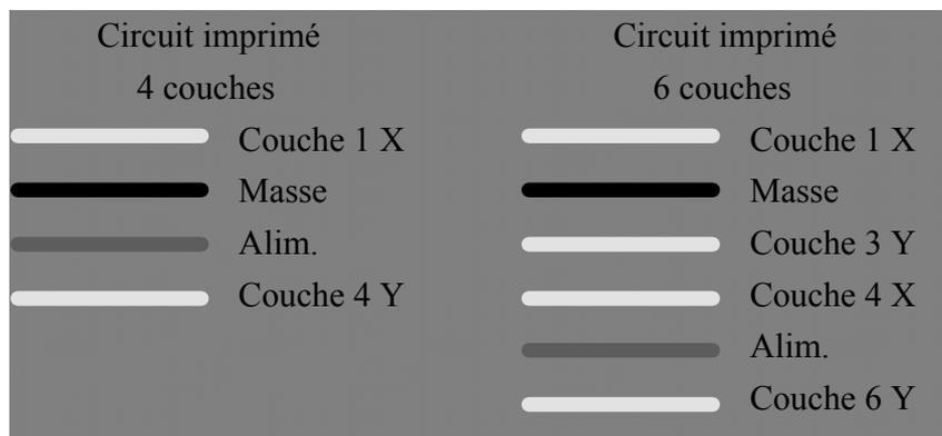
Figure 21 : Exemple de répartition des couches
