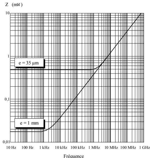
Figure 3 : Impédance d'un plan de masse
