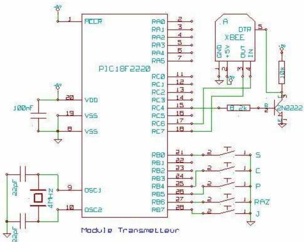
Nota : Les modules XBEE peuvent être remplacés par des modules HC12.
