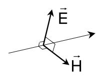
IEI et IHI sont orthogonaux et perpendiculaires à la direction de propagation.
