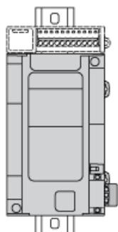
NOTE : Les modules d'extension doivent être montés au-dessus du contrôleur.
