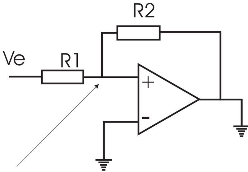
$$V_e R_2 / R_1 + R_2$$
