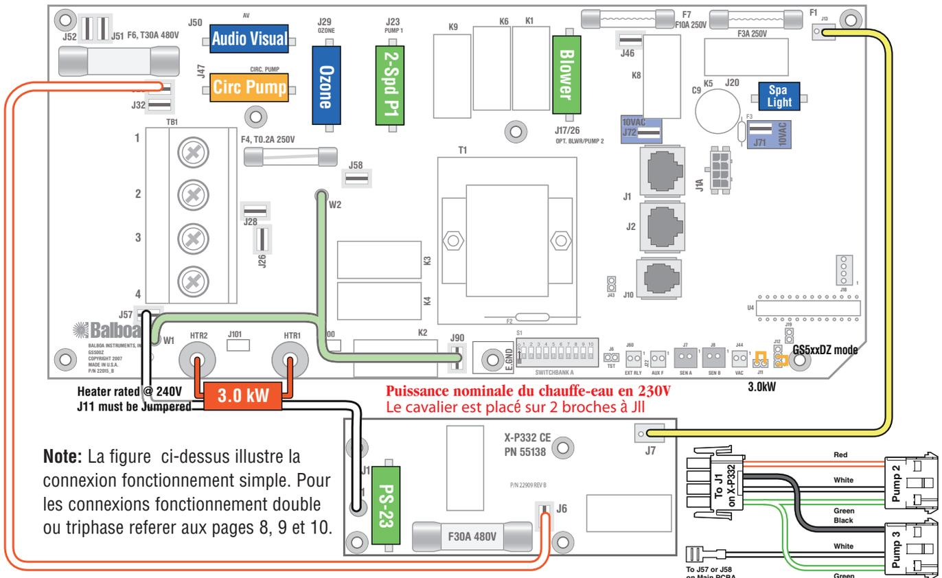
**AVERTISSEMENT :** L'alimentation principale au système doit être COUPEE AVANT de procéder aux configurations des commutateurs DIP.
