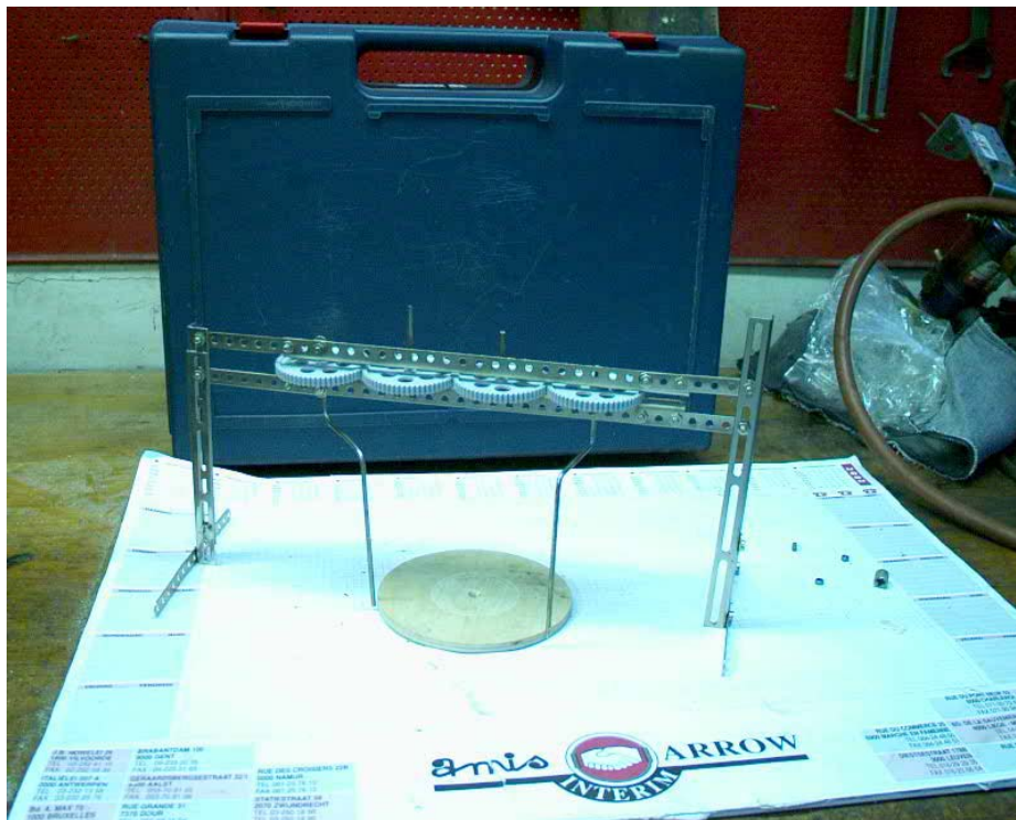
Figure 4 : prototype du "batteur à oeufs"
