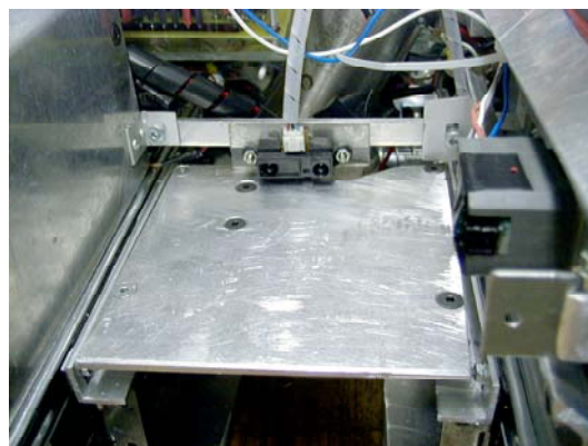
Figure 39 : Le télémètre détecte la présence du palet à l'intérieur du robot
