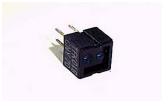
Figure 44 : capteur couleur CNY70
