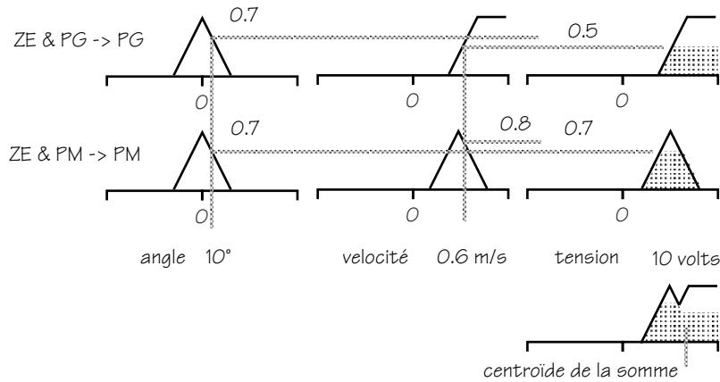
La figure ci-dessus représente pour chaque règle et pour chaque variable sa valeur et son degré d'appartenance à l'ensemble flou référencé dans la clause de la règle. Le calcul de la tension en sortie se fait par la méthode du min-max : le min de l'antécédent écrète le trapèze (ou le triangle) représentant l'ensemble flou du conséquent. On fait alors la somme des surfaces, et on en calcule le barycentre. Sa projection sur l'axe des abscisses donne graphiquement la valeur de sortie.
