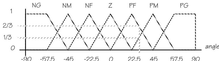
De la même manière, on représentera la vitesse du basculement entre 0 et 1 m/seconde (basculement vers la droite, positif) ou 0 et -1 (vers la gauche, négatif). En utilisant les mêmes symboles, on pourra dire qu'une chute de 40 cm/s est positive moyenne (PM) à 66%, et positive faible (PF) à 33%. Le graphe des fonctions d'appartenance aura l'allure de :
