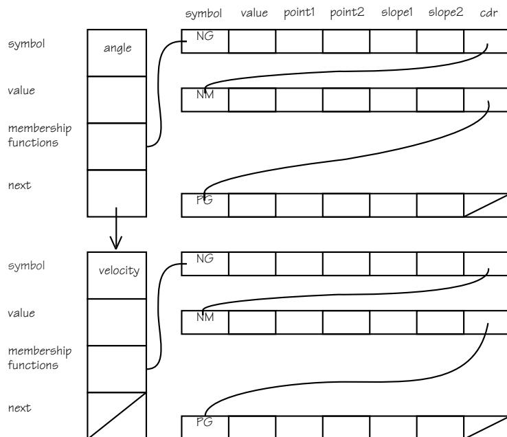
La première liste (cf. structure *Sysin*) est celle des variables d'antécédent et de leurs ensembles flous (cf. structure *Sysin*) : ici, il y a deux variables, donc la liste n'a que deux éléments ; la deuxième liste (cf. structure *Sysout*) n'a, elle, qu'un élément, puisque les conséquents n'ont qu'une clause.
