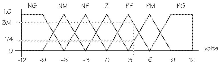
Ces influences sont exprimées par des règles symboliques, qui décrivent la relation désirée entre les paramètres d'entrées et celui de sortie : pour un angle de basculement donné, la réaction du moteur doit être proportionnelle à la vitesse ; de même, à vitesse égale, la réaction du moteur doit être proportionnelle à l'angle de basculement. En l'absence de théorie, de telles règles peuvent être établies intuitivement. Par exemple :
