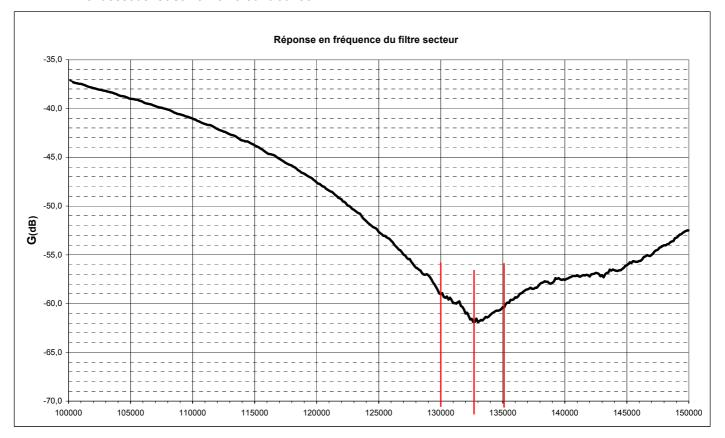
132,5 KHz Fréquence porteuse de la modulation FSK
