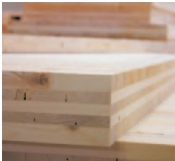
Les éléments Leno consistent en lames d'épicéa contrecollées en plis croisés. Ils sont fabriqués en panneaux jusqu'à 4,80 x 14,80 m, et jusqu'à une épaisseur de 30 cm.
