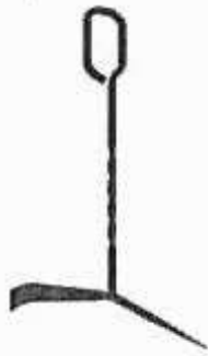
Pic de nettoyage de la corbeille
