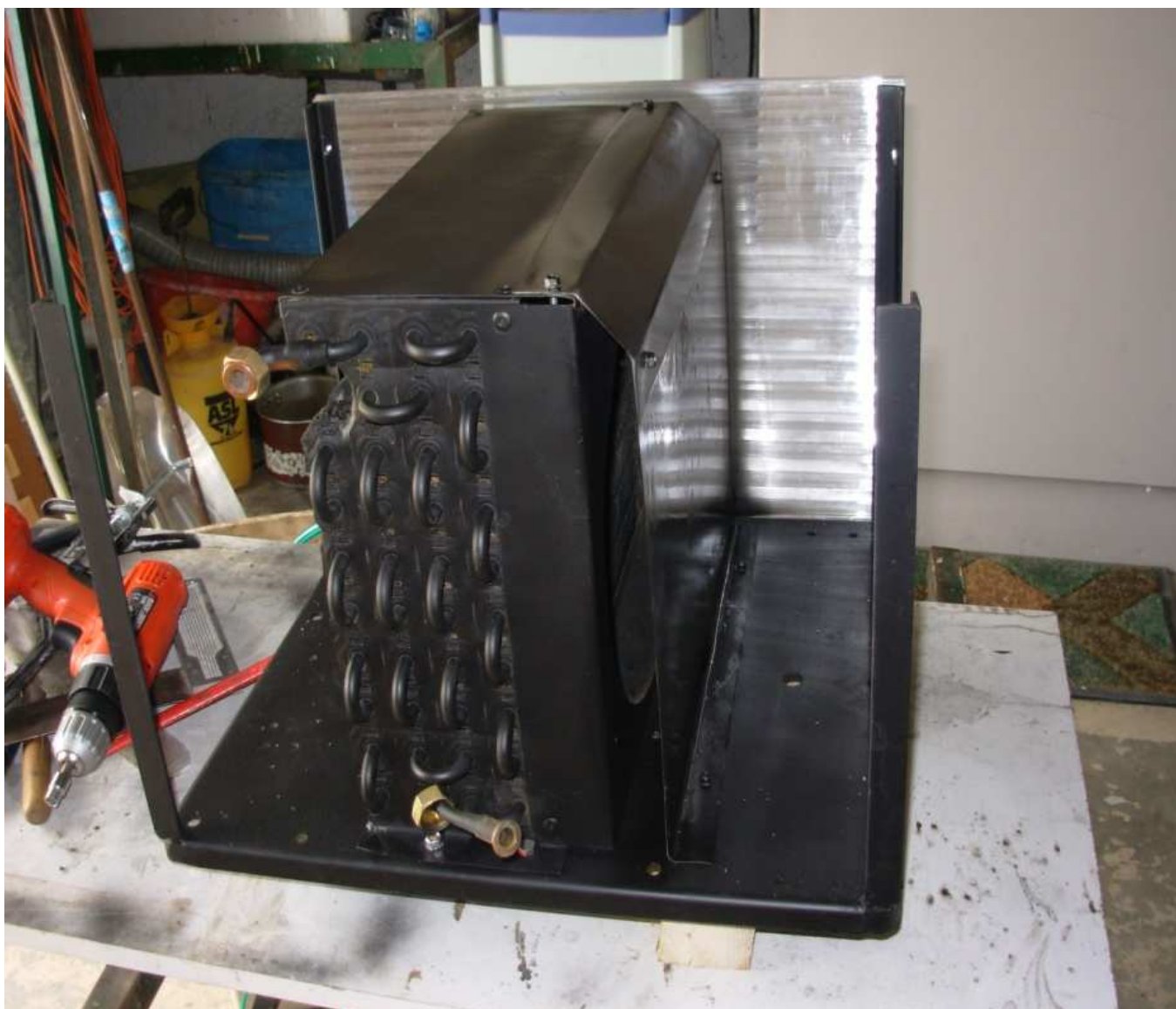
réalisation du groupe air eau mise en place d'une tôle sur la sortie de l'air pour freiner l'air dans le radiateur afin d'avoir un meilleur échange ( a voir pas si sur)
