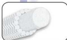
Bourrelet constitué d'une bande de nappe aiguilletée biosoluble. Autour de cette bande est tressé un guipage (maille de 1, 3 ou 4 mm) en fils de fibres biosolubles renforcés de fils d'acier réfractaire.
