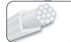
Tresse carrée de haute densité et très solide. Sur une âme (constituée de fils tordus de fibres céramiques) sont tressés de manière très serrée des fils de fibres céramiques, renforcés de fils de fibres de verre ou d'acier réfractaire.
