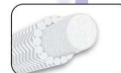
Bourrelet constitué d'une bande de nappe aiguilletée céramique. Autour de cette bande est tressé un guipage (maille de 1, 3 ou 4 mm) en fils de fibres céramiques renforcés de fils d'acier réfractaire.
