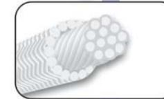
Tresse ronde de haute densité et très solide. Sur une âme (constituée de fils tordus de fibres céramiques) sont tressés de manière très serrée des fils de fibres céramiques, renforcés de fils de fibres de verre ou d'acier réfractaire.
