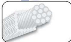
Tresse carrée de haute densité et très solide. Sur une âme (constituée de fils tordus de fibres biosolubles) sont tressés de manière très serrée des fils de fibres biosolubles, renforcés de fils de fibres de verre ou d'acier réfractaire.
