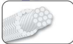
Tresse ronde de haute densité et très solide. Sur une âme (constituée de fils tordus de fibres biosolubles) sont tressés de manière très serrée des fils de fibres biosolubles, renforcés de fils de fibres de verre ou d'acier réfractaire.
