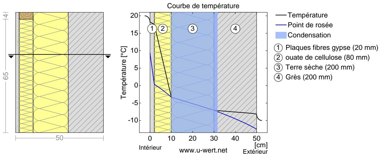
Links: Maßstäbliche Zeichnung des Bauteils. Rechts: Verlauf von Temperatur und Taupunkt an der in der linken Abbildung markierten Stelle. Der Taupunkt kennzeichnet die Temperatur, bei der Wasserdampf kondensieren und Tauwasser entstehen würde. Solange die Temperatur der Konstruktion an jeder Stelle über der Taupunkttemperatur liegt, entsteht kein Tauwasser. Falls sich die beiden Kurven berühren, fällt an den Berührungspunkten Tauwasser aus.
