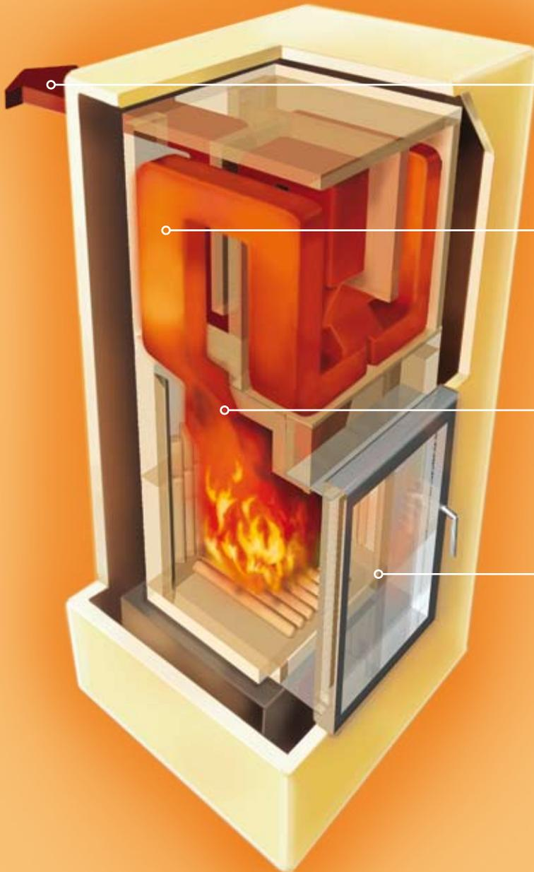
Les gaz de fumées répondant aux normes antipolluantes se composent de CO<sub>2</sub> et de vapeur d'eau. Ces gaz ne contiennent plus qu'environ 10% de l'énergie produite lors de la combustion.
