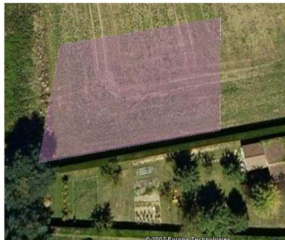
Puis dans GS, cliquer sur « get the current view » (terre bleue et flèche jaune). On se retrouve avec l'image du terrain dans GS et on peut alors dessiner des formes 3D représentant grossièrement (ou finement si on est expert avec GS) les dimensions des objets pouvant être des masques et les mettre à « leur place » sur la photo (dans l'exemple : une haie de tuyas de 2m parallélépipédique plus deux conifères cylindriques de 6m de haut dans mon cas et un parallélépipède pour ma maison)
