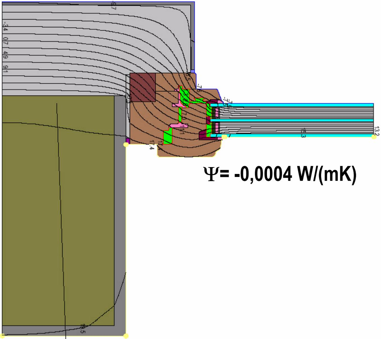
Beschreibung: Wand Kalksandstein ( $\lambda=1,0 \text{ W/mK}$ ), WDVS 12cm Fenster überdämmt. Der leicht negative PSI-Wert resultiert aus dem U-Wert der Wand von  $0,26 \text{ W/m}^2\text{K}$ .
