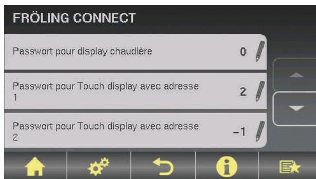
Dans ce menu, il est possible de modifier les mots de passe de l'écran tactile de la chaudière et de définir un mot de passe pour 7 autres écrans tactiles (tableaux de commande) de l'installation.
