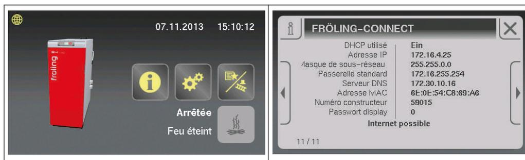
La chaudière est configurée pour l'accès via froeling-connect.
