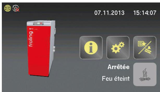
**REMARQUE !** Si la chaudière est éteinte à l'écran de la chaudière (état de fonctionnement « Chaudière ARRET »), la gestion à distance est automatiquement désactivée pour des raisons de sécurité. Si nécessaire, elle peut être réactivée dans le Connection Center !
