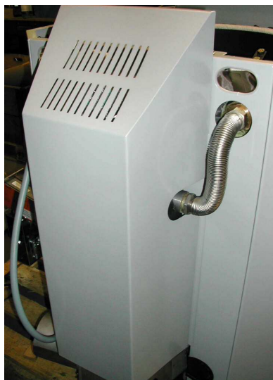
Echangeur de condensation
