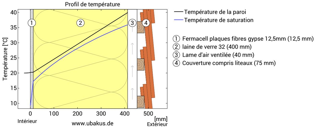
Course de la température et du point de rosée dans la composition. Le point de rosée indique la température à laquelle la vapeur d'eau condensera. Si la température de la composition est au dessus de température de condensation il n'apparaît pas d'eau liquide. Si les deux courbes viennent à se toucher, il se forme en ce point de la condensation.
