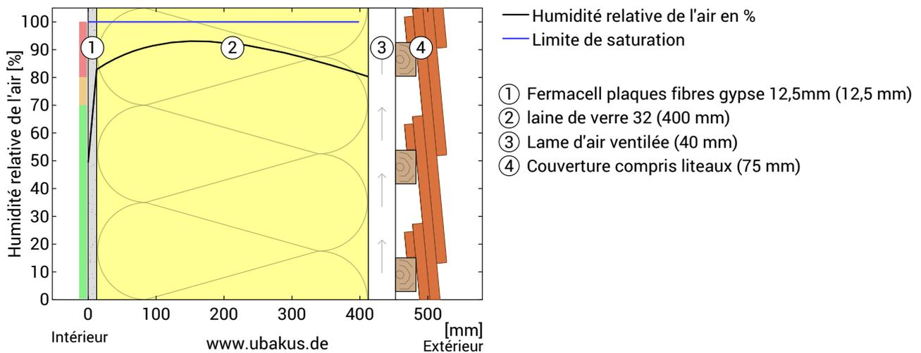
Notes: Calcul utilisant la méthode 2D-FE d'Ubakus. La convection et la capillarité des matériaux de construction n'ont pas été prises en compte. Le temps de séchage peut prendre plus de temps dans des conditions défavorables (ombrage, étés humides / frais) que celui calculé ici.
