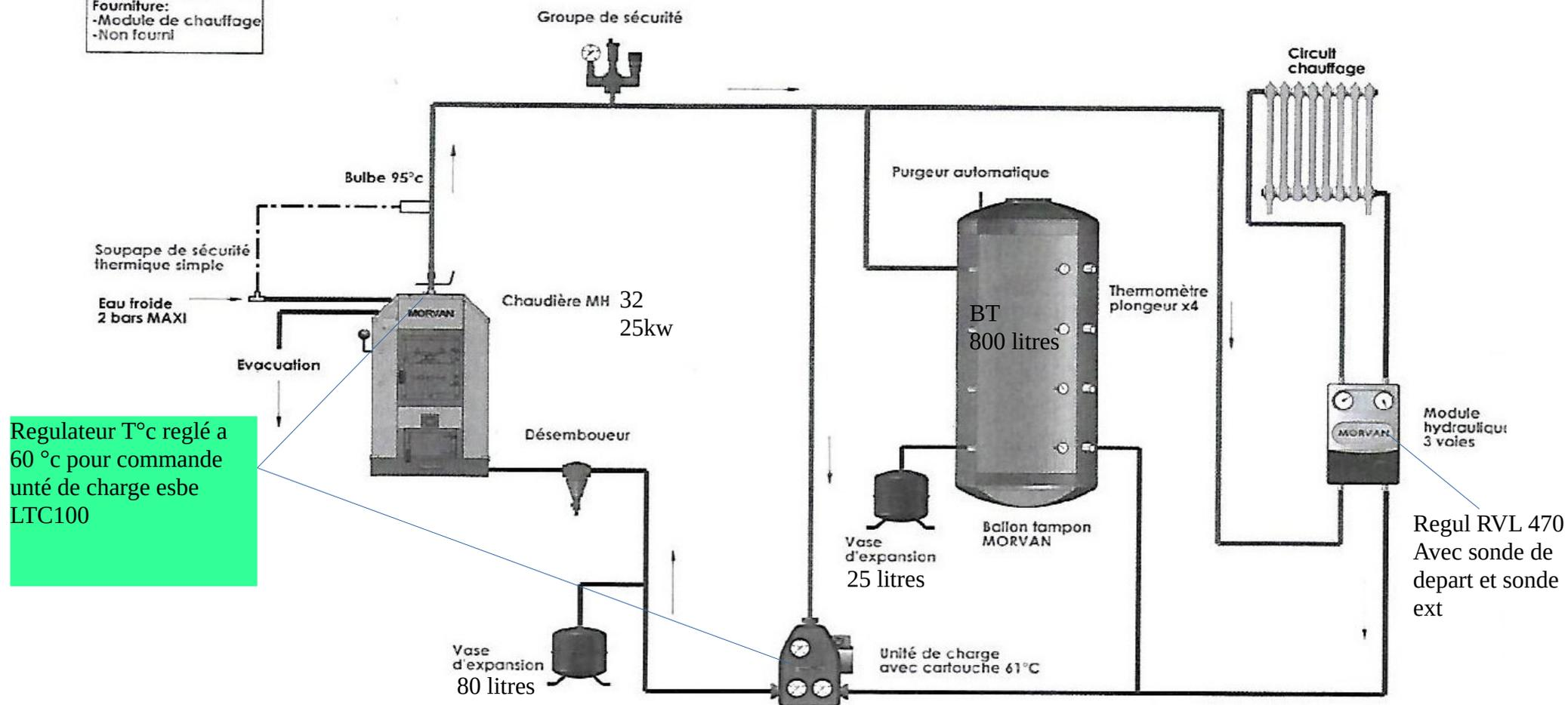
Regulateur T°C réglé à 60 °C pour commande unité de charge esbe LTC100
