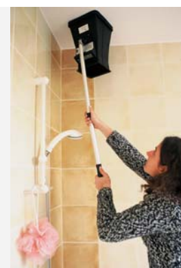
Mesure du débit d'air extrait aux bouches d'extraction
