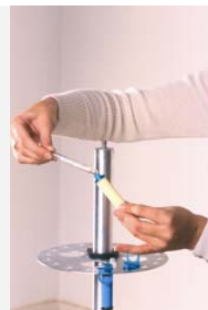
Support adsorbant solide utilisé pour les prélèvements de COV et d'aldéhydes
