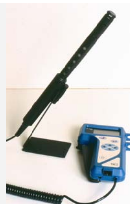
Appareil de mesure de la température, de l'humidité relative et du dioxyde de carbone (Q-Track)
