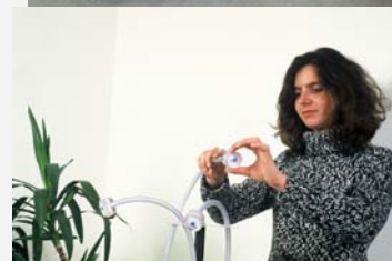
Prélèvement d'air à prise totale pour les allergènes
