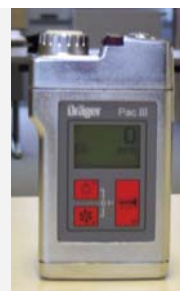
Détecteur électrochimique de CO à mesurage direct
