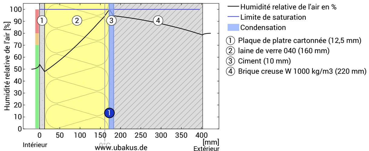
Notes: Calcul utilisant la méthode 2D-FE d'Ubakus. La convection et la capillarité des matériaux de construction n'ont pas été prises en compte. Le temps de séchage peut prendre plus de temps dans des conditions défavorables (ombrage, étés humides / frais) que celui calculé ici.
