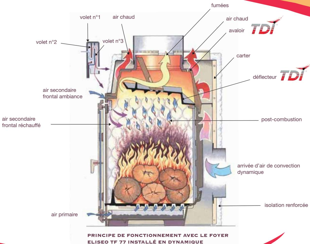
Les performances exceptionnelles (81,6 % de rendement pour le foyer ELISEO 77) sont obtenues principalement grâce à l'action conjuguée d'un ensemble Avaloir + Déflecteur de fumées **TDI** avec un système de préchauffage de l'air secondaire frontal composé de 1 ou 2 jeux de triple volets multiperforés. Ce dernier agencement est multifonction puisqu'il participe activement à l'efficacité du principe VITRE CLAIRE<sup>®</sup> de **TURBO FONTE**.
