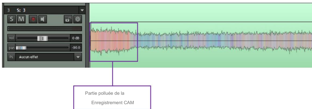
Figure 18 : Pollution d'enregistrement CAM - aperçu de la forme d'onde
