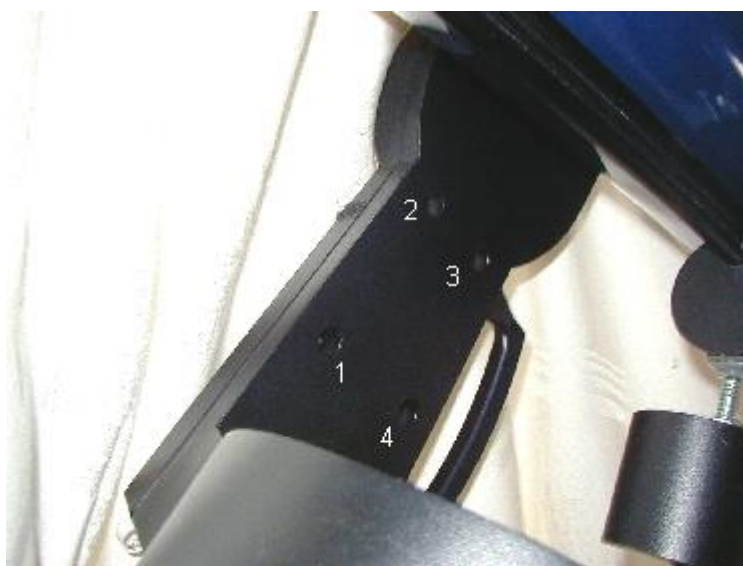
Image 1 - Les quatre emplacements de vis sur le bras de fourche interne
