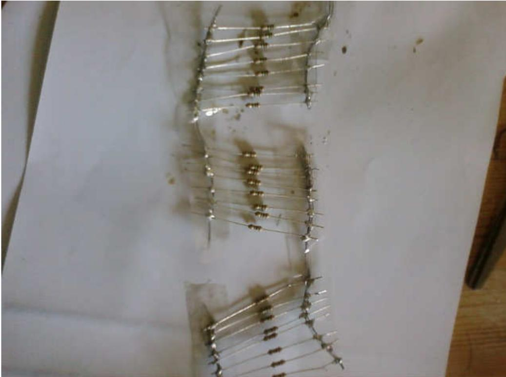
Placer les résistances soudées entre les deux bandes de mousses, laisser sortir suffisamment de fil aux deux extrémités :
