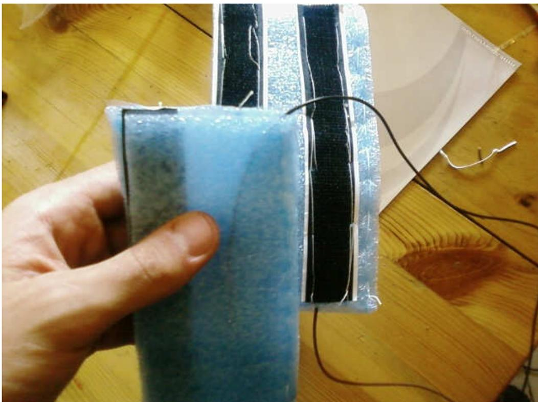
Adapter les deux embouts de fils restants à l'alimentation 12V (j'ai utilisé deux petits clous capables de rentrer dans la prise d'alimentation et j'ai soudé les deux fils dénudés aux extrémités) :
