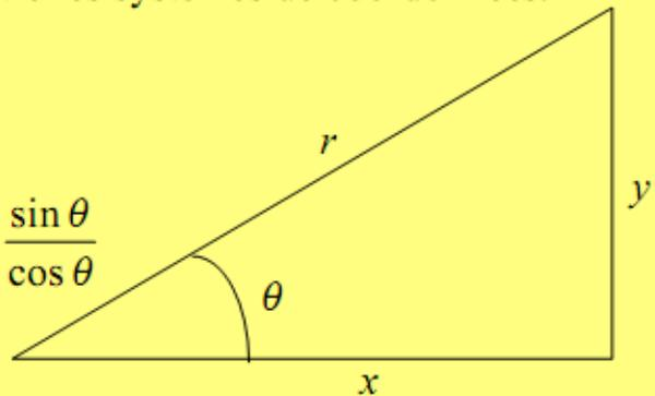
Le rapport de la fonction **sinus** (d'un angle donné) à la fonction **cosinus** (du même angle) fournit la **tangente** de cet angle.
