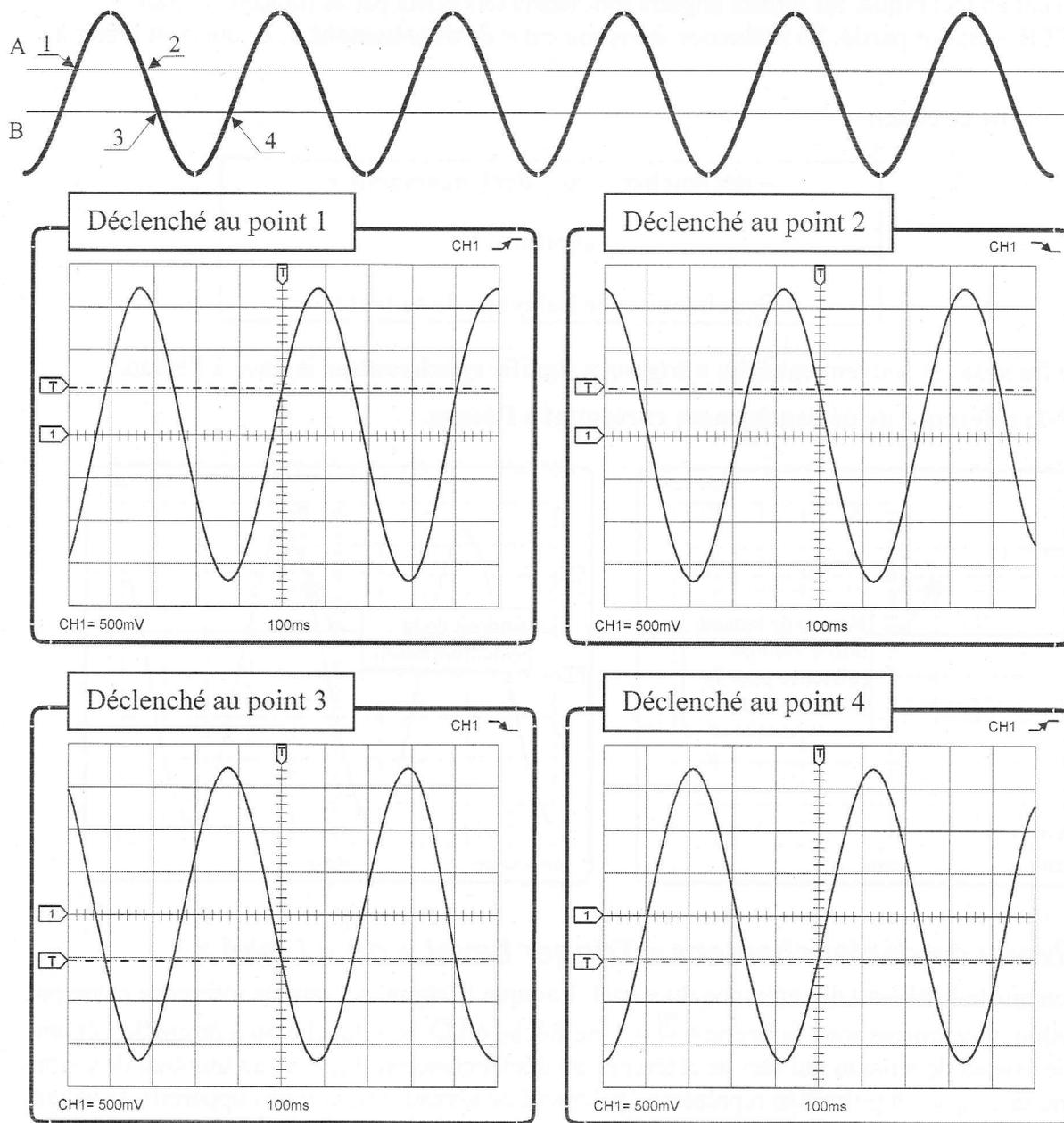
Nous pouvons constater que pour un même niveau de déclenchement, par exemple la tension de référence « A », il y a deux endroits possibles pour commencer le signal. Il est en effet possible de commencer au point « 1 » ou au point « 2 ». La différence entre les deux est le sens de passage du signal, indiqué en haut à droite des écrans ci-dessus :
