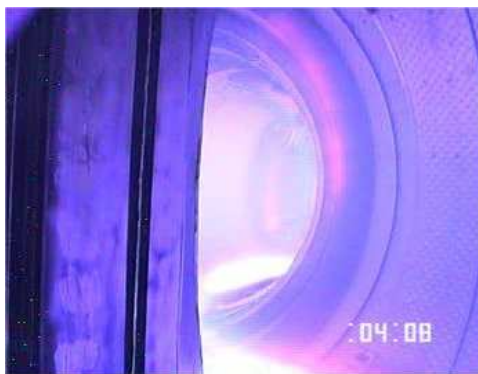
Décharge de plasma dans Tore Supra en appui sur le limiteur pompé toroïdal de l'installation. © CEA.
