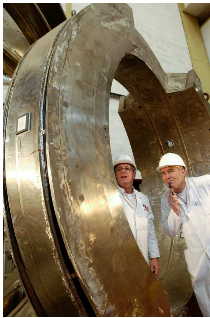
Bobine toroïdale supraconductrice de Tore Supra, réalisée dans un alliage de niobium-titane. © P. Stroppa/CEA
