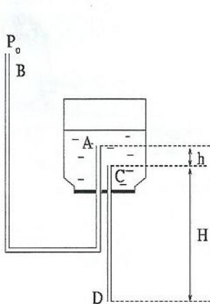
Un flacon **rigide** partiellement rempli de liquide et fermé par un bouchon traversé par deux tubes flexibles AB et CD est placé verticalement comme l'indique la figure ci-contre. Les extrémités A et C des deux tubes se trouvent au sein du liquide. L'extrémité B débouche à l'air libre à la pression atmosphérique  $P_0 = 1013 \text{ hPa}$ .
