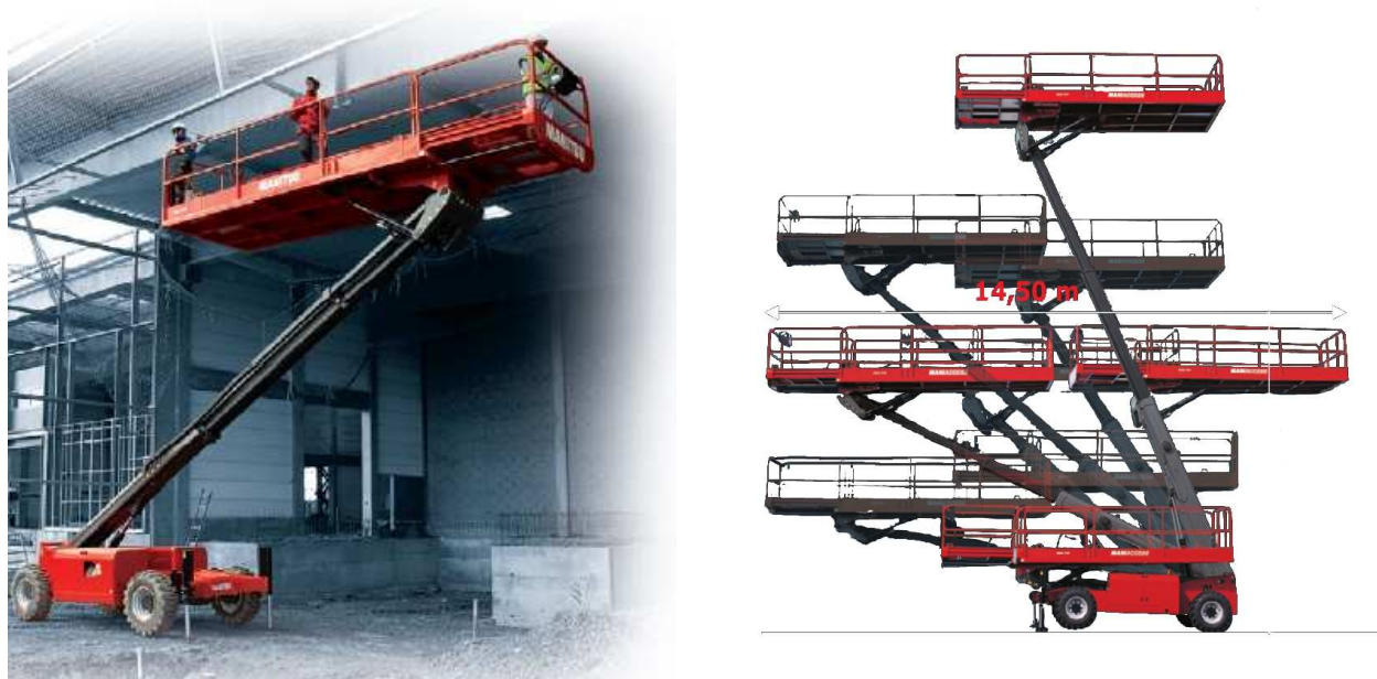
FIG. 1. Plateforme télescopique ( http://www.fr.manitou.com ) : plateforme sur chantier et illustration des différentes positions possibles
