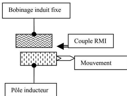
**En sortie d'équilibre stable**, quand les pôles inducteurs quittent la position face aux circuits magnétiques induits. Les champs magnétiques (inducteur et RMI) s'additionnent pour freiner la rotation.
