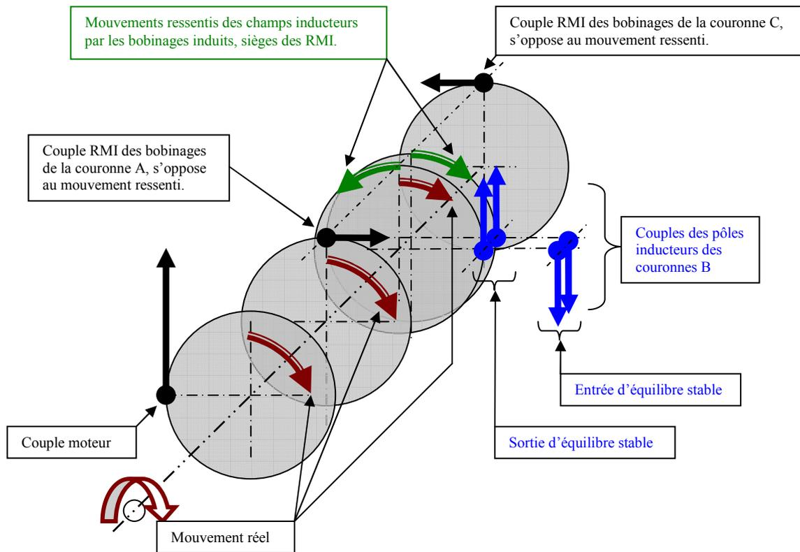
Aucun pôle de compensation n'est nécessaire et aucune énergie spécifique n'est utilisée pour contrebalancer les réactions magnétiques induites auto équilibrées.
